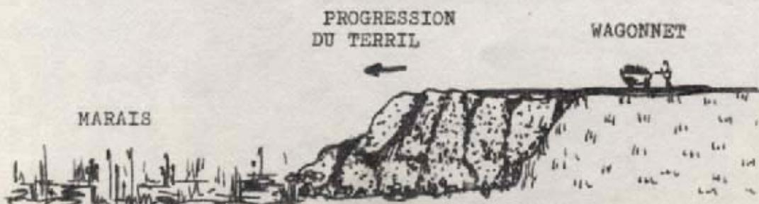
Les terrils en plateau (fig.4) sont obtenus un peu de la même façon; les différences sont que l'accès se fait à l'aide d'un plan incliné, que l'apport se fait à l'aide de camions ou de wagons et que l'on nivelle l'accès au bulldozer; la surface du terril prend alors l'aspect indiqué sur la figure 5.
